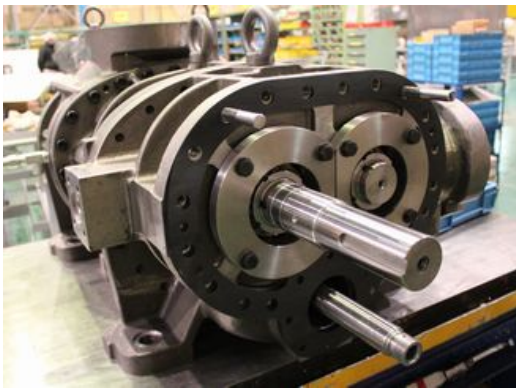
Photo 093 Stud Bots and Gasket
